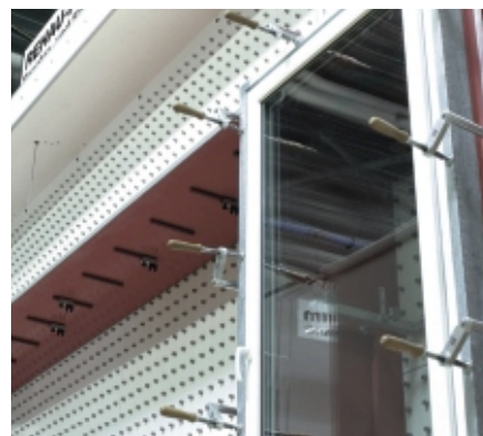
Echiptament de testare pentru presiunea vântului
