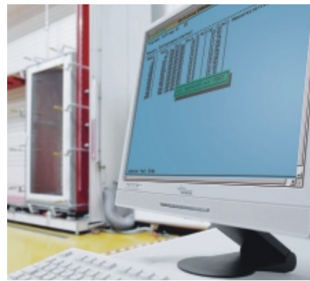
Testarea etanșeității la ploaia torențială
