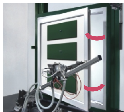
Echiptament pentru testarea ferestrelor la solicitări intense
